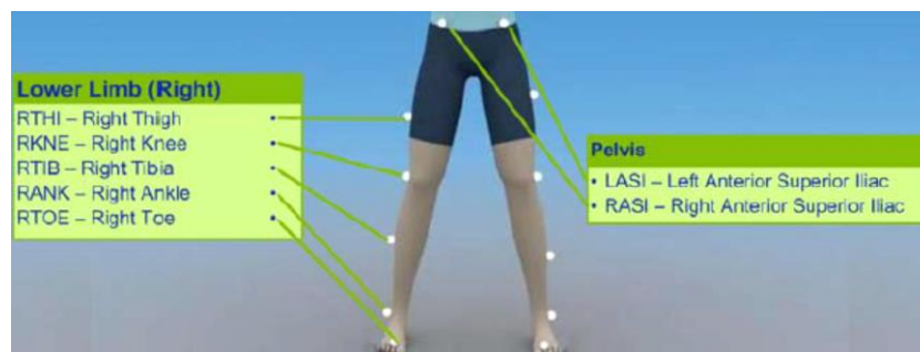
Abbildung 3: Markerpositionen des Plug-In-Gait-Modells von ventral; entnommen aus: Vicon, 2007
