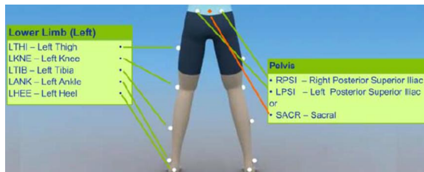
Abbildung 4: Markerpositionen des Plug-In-Gait-Modells von dorsal; entnommen aus: Vicon, 2007
